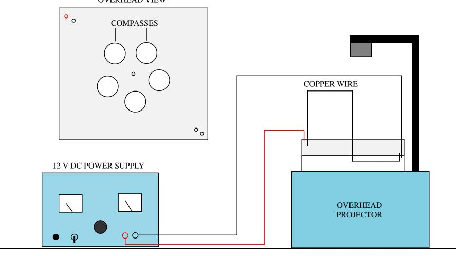
ARRANGE COMPASSES AROUND THE CENTER WIRE.
