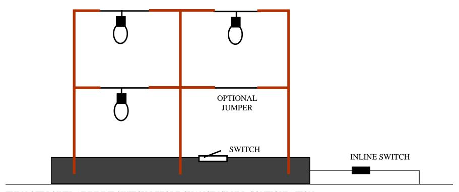
TURN OFF POWER AT INLINE SWITCH BEFORE CHANGINGBULB CONFIGURATION.
