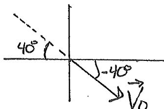
$$V_{0,x} = 7\text{ m/s} \cos(40^\circ) = 5.362\text{ m/s}$$
