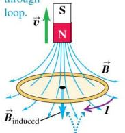
(d) Motion of magnet causes increasing upward flux
