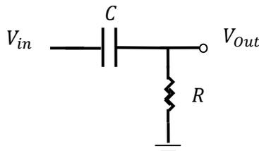
**Figure 2.** RC circuit (2).
